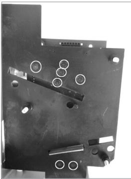
**5** Reinigen Sie die untere feste schwarze Platte mit einem in Spiritus getränkten, weichen Lappen. Reinigen Sie dabei speziell die Sensorpunkte oberhalb des oberen Längsschlitzes und die zwei Sensorpunkte unten vor der Austrittsöffnung.
