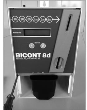
**3** Senken Sie die Front nun um ca. 2 cm ab und ziehen Sie diese vorsichtig aus dem Gerät. Ziehen Sie das Kabel, das die Front mit der Schalteinheit verbindet, hinten an der Front aus. Achten Sie dabei darauf, dass Sie die Steckerverriegelung betätigen um den Stecker zu entfernen.
