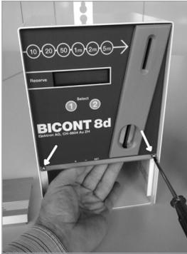
**2** Lösen Sie die zwei seitlichen Schrauben am Aufsatz mit einem Kreuzschlitzschraubendreher und halten Sie die Front hierbei mit einer Hand in ihrer Position.
